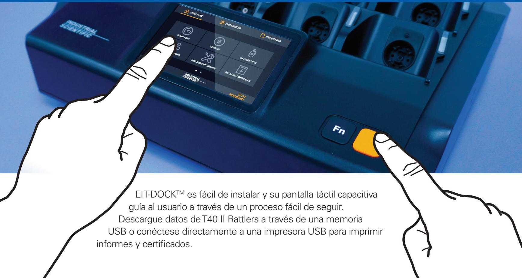
EIT-DOCK™ es fácil de instalar y su pantalla táctil capacitiva guía al usuario a través de un proceso fácil de seguir.
