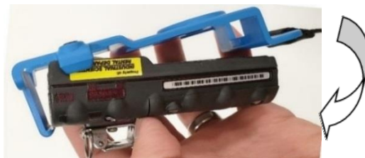
Figura 2 Inserimento e rimozione della Standby Clip
