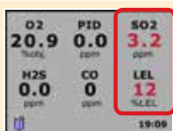
Zdarzenie dolnej granicy alarmowej stężenia gazu
