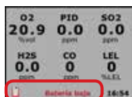
Evento de alarma baja de batería
